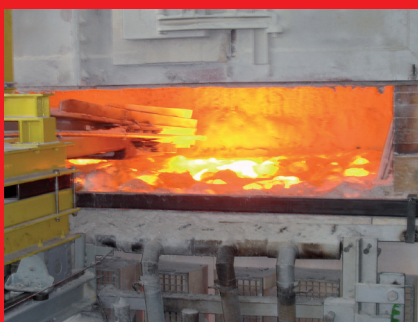
Ingredientes de vidro derretido em um tanque
